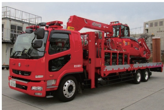
重機及び重機搬送車
